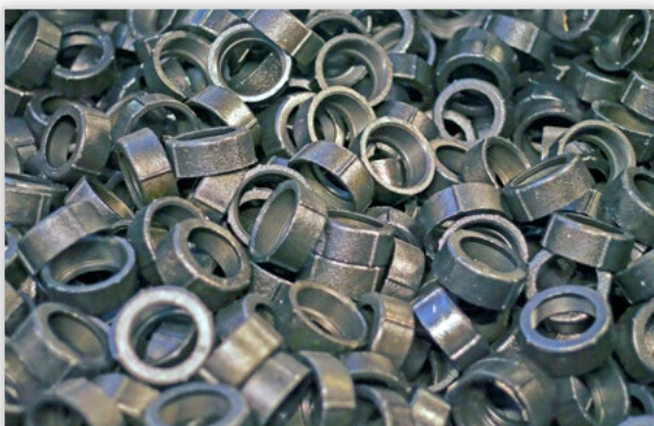
Nakrętki zaciskowe Gebo jako jeden z elementów budowy złączek Gebo Quick
