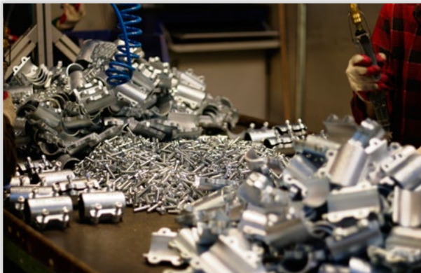
Produkcja: montaż obejm DSK na hali produkcyjnej w Markach
